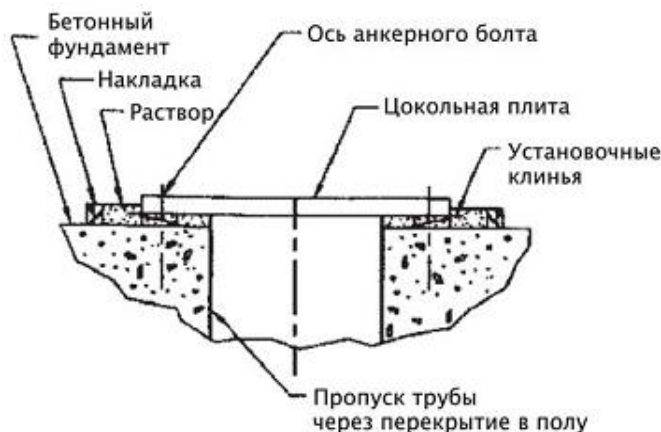
Рис. 6 Установка плиты по уровню
