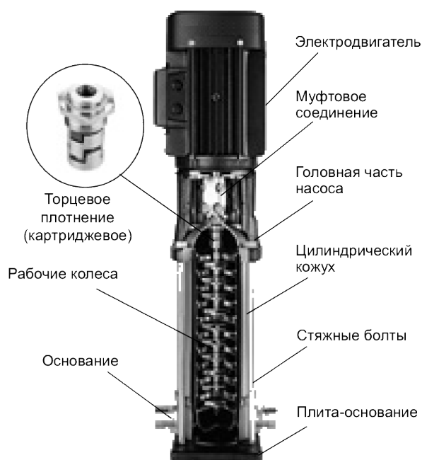
Рис. 5 Конструкция насоса CDL/CDLF
