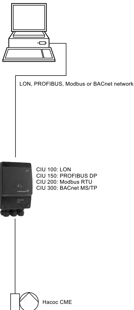
Рис. 19 Структура централизованной системы диспетчеризации здания
