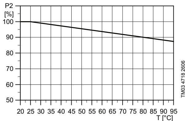
Рис. 19 Соотношение мощности двигателя (P2) и температуры окружающего воздуха
